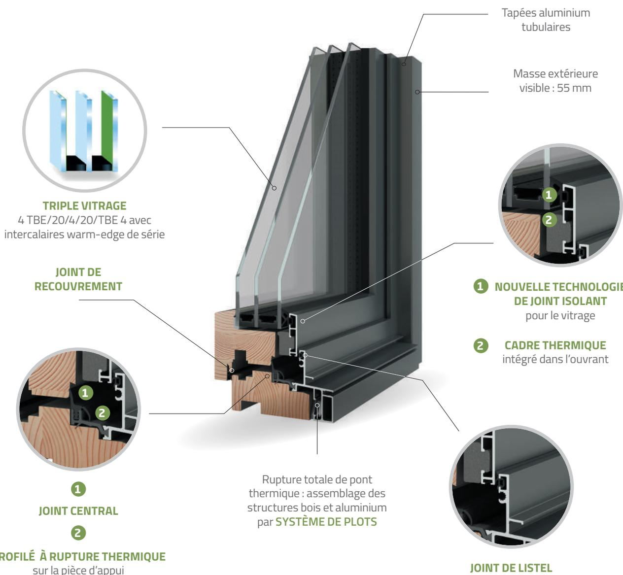
(3) Performance thermique pour une fenêtre 1 vantail en pin avec  $U_g$  de 0,5 et intercalaire we+, format CE (H 1,48 x L 1,25)
